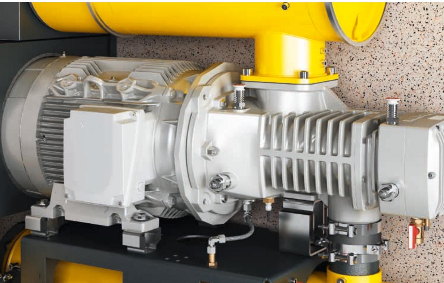
В винтовых воздуховках серий CBS, DBS и EBS передача мощности от двигателя блоку воздуховки осуществляется через редуктор. Такое решение (при данном числе оборотов) обеспечивает оптимальный КПД, надежность и наиболее продолжительный срок службы. В установках серии HBS передача мощности осуществляется без потерь через муфту сцепления. Применение этих концепций стало результатом глубоких исследований, проведенных в конструкторско-исследовательских центрах KAESER.
